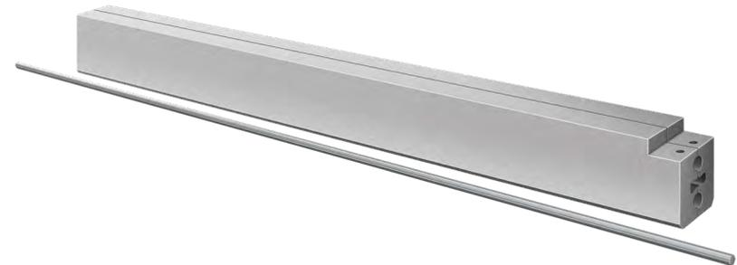
Der Hexagon Guide kann die Installation einer Pivot Tür vereinfachen. Der Mindest-Abstand vom Drehpunkt zur Türkante beträgt 91 mm und der maximale Abstand reicht bis zur Türmitte. Beträgt der Abstand vom Drehpunkt zur Türkante mehr als 280 mm, empfehlen wir den Hexagon Guide, um Ihnen die Installation zu erleichtern.
