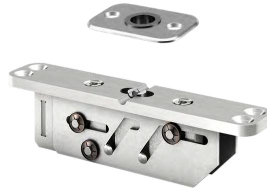
Das Cable Grommet ist eine Erweiterung des Zapfenbands oben und ermöglicht Ihnen eine Verkabelung in der Tür. Es enthält eine interne Kabeltülle von  $\varnothing 7,5$  mm. Diese Version des Zapfenbands oben steht bei allen FritsJurgens Systemen als Set zur Verfügung und ersetzt das Standard-Zapfenband oben und die Deckenplatte.
