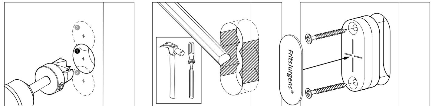
WIR EMPFEHLEN DIE VERWENDUNG VON: FORSTNERBOHRER Ø22mm
