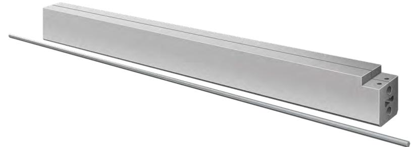
Hexagon Guide peut faciliter l'installation de la porte sur pivot. La distance minimale du point de rotation au bord de la porte est de 91 mm et la distance maximale est le milieu de la largeur de la porte. Si le point de rotation est à plus de 280 mm du bord de la porte, nous proposons Hexagon Guide pour faciliter l'installation.
