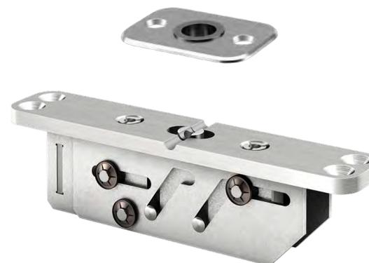
Le Passe-câble est un ajout à la gamme existante de pivots supérieurs de FritsJurgens et permet le câblage de la porte. Ce pivot supérieur contient un passe-câble intégré de  $\varnothing 7,5$  mm. Cette version du pivot supérieur est disponible avec tous les systèmes FritsJurgens et remplace le pivot supérieur standard fourni et la plaque de plafond avec un set complet.
