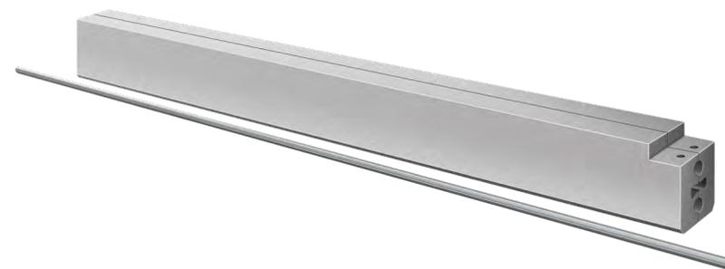
La guida esagonale Hexagon Guide agevola l'installazione della porta a bilico. La distanza minima necessaria tra l'asse di rotazione e il margine della porta è 91 mm, quella massima corrisponde al centro stesso dell'anta. Nel caso in cui il punto di rotazione disti oltre 280 mm dal margine della porta, la guida esagonale Hexagon Guide ne agevolerà l'installazione.
