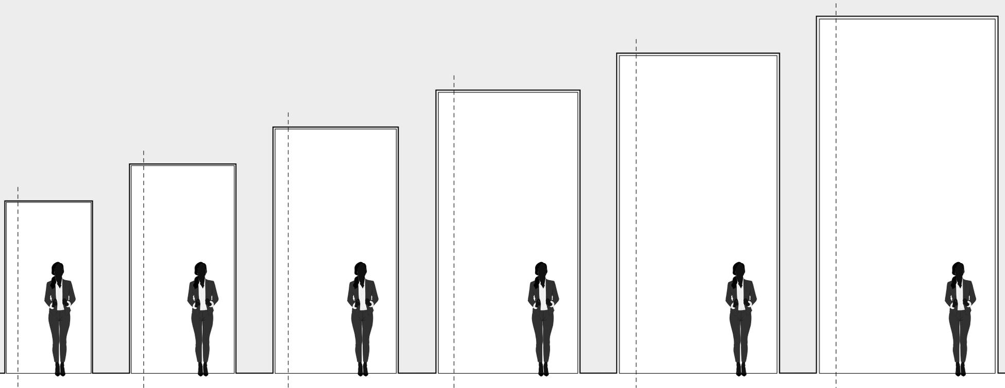
FritsJurgens Pivot Systeme sind für leichte und schwere Türen geeignet. Die System M+ Modelle sind für Türen von 20 bis 500 kg ausgelegt. System M bietet sich für Türen zwischen 20 und 210 kg an. System One unterstützt ebenfalls Türen bis zu 500 kg, während System 3 für Türen zwischen 40 und 350 kg ausgelegt ist. Die Gestaltungs-Möglichkeiten der Türen sind endlos und die Bewegung immer sanft und flüssig.
