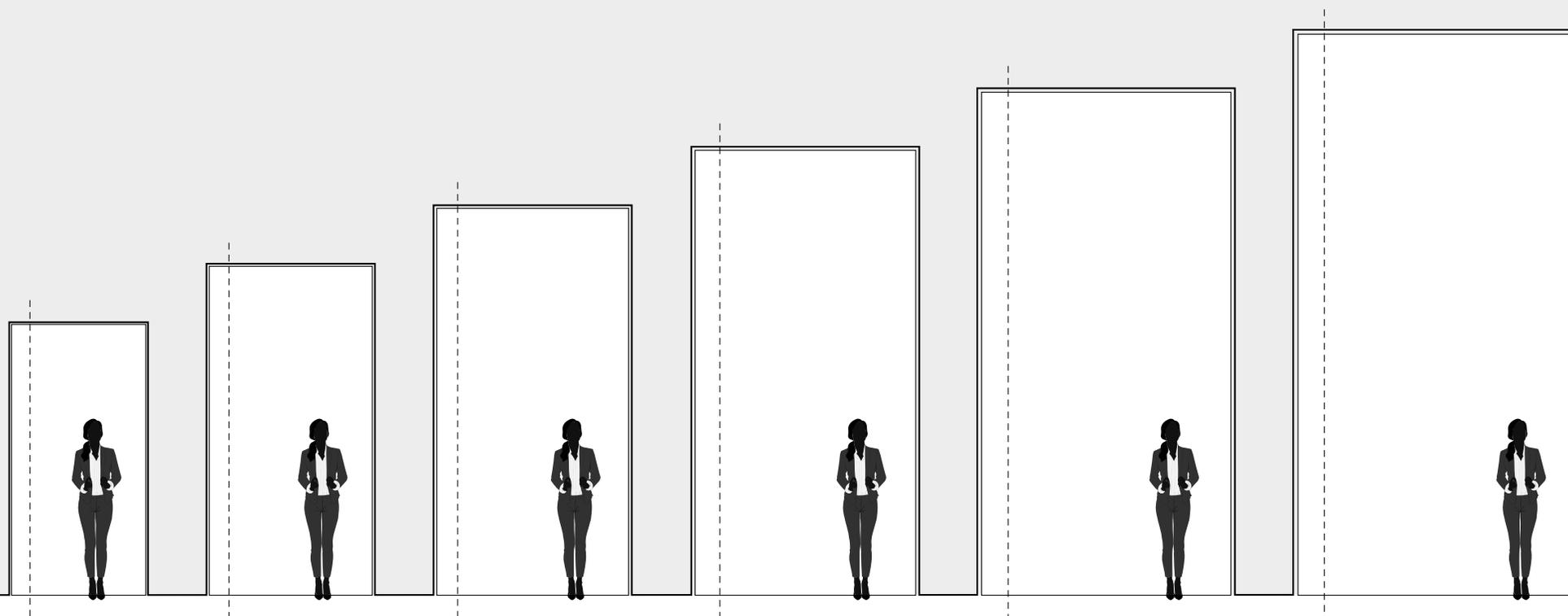
Tous les systèmes de charnières à pivot FritsJurgens conviennent aux portes légères comme aux portes lourdes. System M+ convient aux modèles de portes de 20 à 500 kg. System M convient aux portes de 20 à 210 kg. System One supporte aussi des portes allant jusqu'à 500 kg, tandis que System 3 supporte des portes de 40 à 350 kg. Les possibilités pour le design de la porte sont infinies et le mouvement est fluide et léger.
