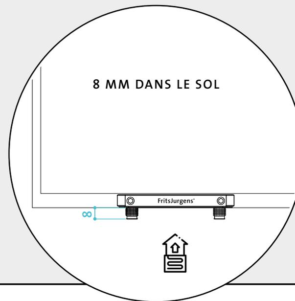
Les composants des systèmes de charnières à pivot du pivot supérieur et du pivot inférieur sont entièrement insérés dans la porte sur pivot. Seules les petites plaques de sol et de plafond sont visibles. Les bagues de la crapaudine doivent seulement être insérées de 8 mm dans le sol, ce qui signifie que tous les systèmes FritsJurgens peuvent aussi être utilisés en association avec un système de chauffage par rayonnement au sol.
