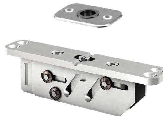
La cerniera superiore con foro passacavo Cable Grommet rende possibile il passaggio invisibile di cavi attraverso l'anta, consentendone il cablaggio. Questa speciale cerniera superiore è dotata di foro passacavo integrato da  $\varnothing 7,5$  mm. La cerniera superiore in variante foro passacavo, completa di rispettiva piastra a soffitto, può essere fornita – in alternativa ai corrispondenti modelli standard – assieme a ciascuno dei kit FritsJurgens.
